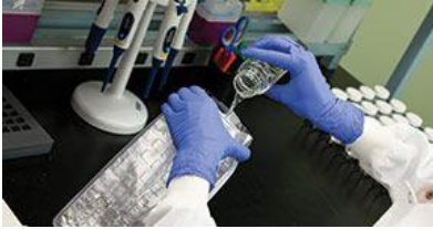
Step 4a: Pour into Quanti-Tray 2000
